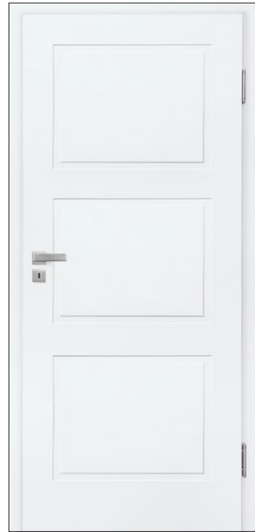
VIGO – Türblatt Weißlack (ähnlich RAL 9016), Designkante, Magnetschloss, 3-tlg. Bänder Edelstahloptik, mit und ohne Schlüssellochbohrung
