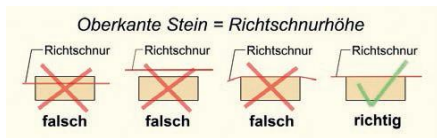
Bild zeigt das korrekte Anlegen der Richtschnur
